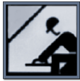
5. Hoàn thiện bằng bàn xoa hoặc máy xoa
