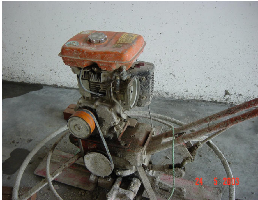
Hình 2. Máy xoa nền chuyên dụng
